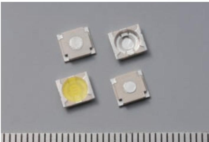
照片1 通过MID实现的高导热封装结构
