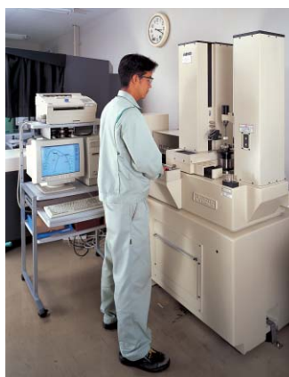
评价齿轮精度用的真圆度测试机(上) 和 JIS 齿轮精度试验机
