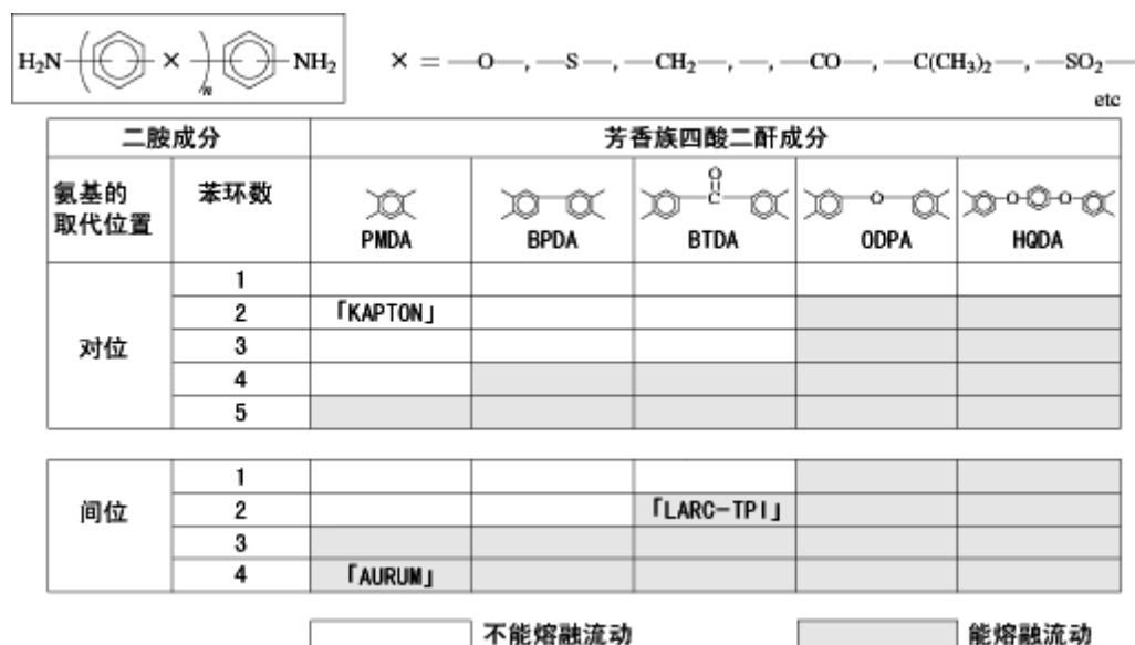
图 2 聚酰亚胺结构与熔融流动性的关系简略图
